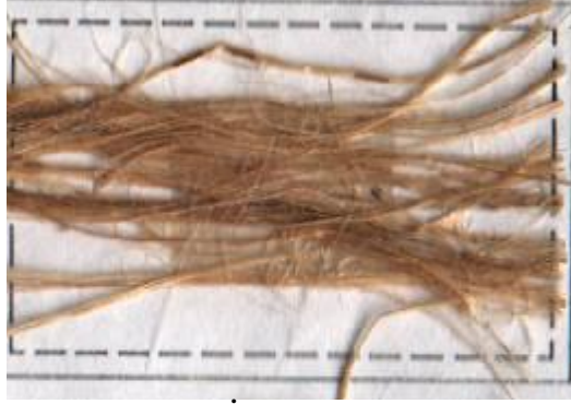
Şekil 1.6. Mikroskop Altında İncelenmesi için Hazırlanmış Keten Lifi
